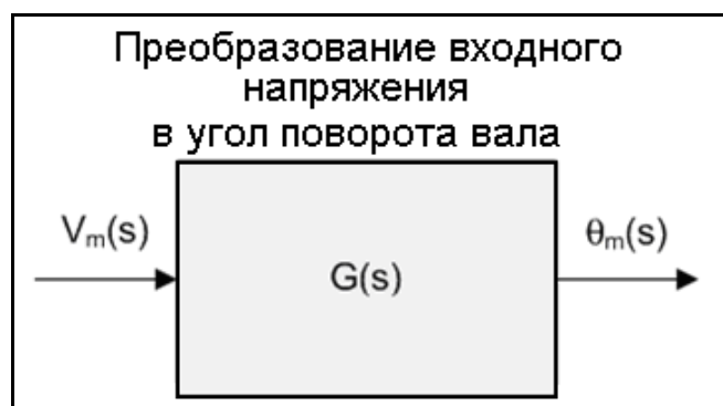
Рис. 3.1. Представление ДС-мотора как линейного динамического звена с коэффициентом передачи G(s) от подаваемого напряжения к углу поворота вала
