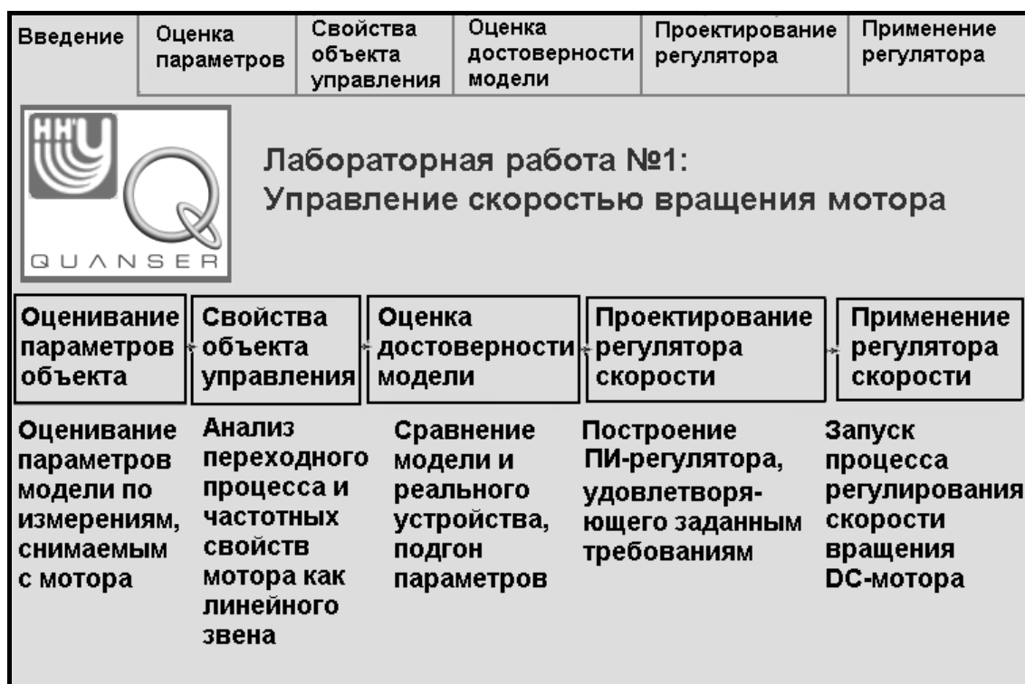
Рис. 2.2. Вид главного окна виртуального прибора с описанием этапов эксперимента в лабораторной работе по управлению скоростью вращения
