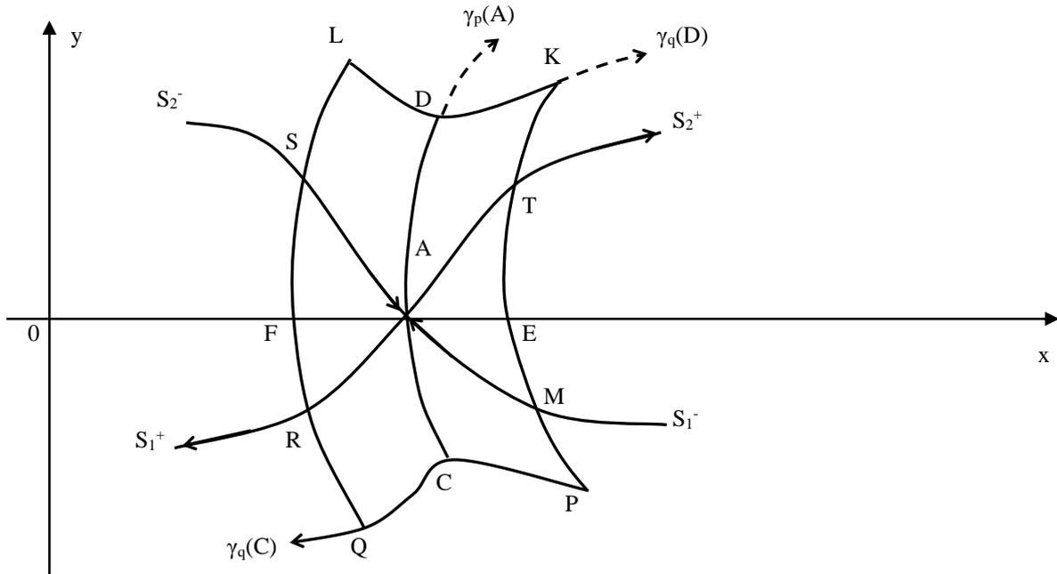
Рис.3.3. Поведение траекторий  $p$ -системы и  $q$ -системы в окрестности седла  $q$ -системы.
