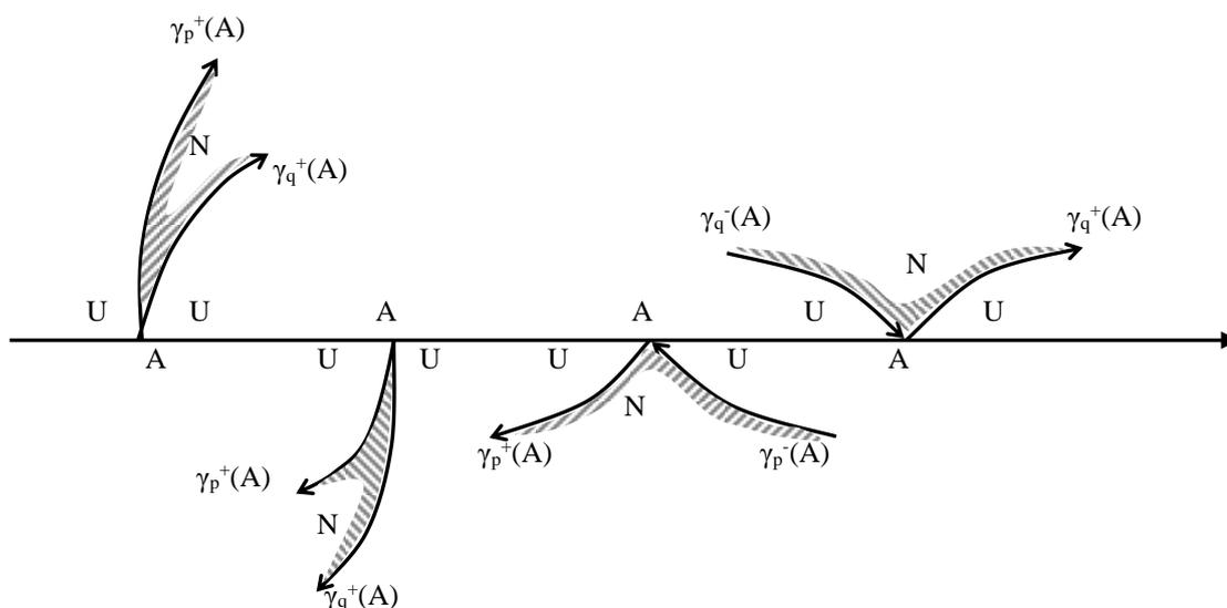
Рис.3.8. Варианты структуры границы области управляемости в окрестности двусторонней граничной точки.
